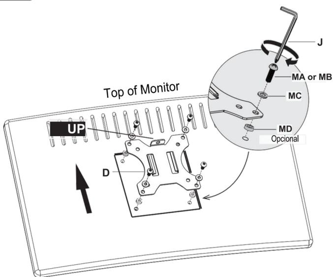
**⚠** Não aperte os parafusos excessivamente ou aperte-os usando a parafusadeira, ou seu monitor poderá ser danificado.
