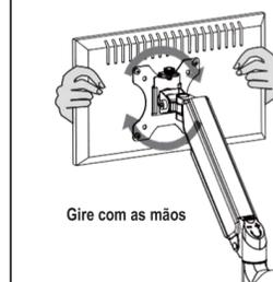
**Nota:** Para garantir a estabilidade, o aperto do eixo rotativo foi predefinido, por isso seria um pouco difícil girar a placa VESA sem o monitor.
