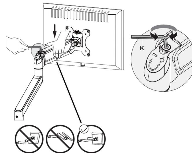
**Observação:** Certifique-se de manter o braço na posição horizontal durante o ajuste. Caso contrário, seria difícil ajustar a montagem ou danificá-la.
