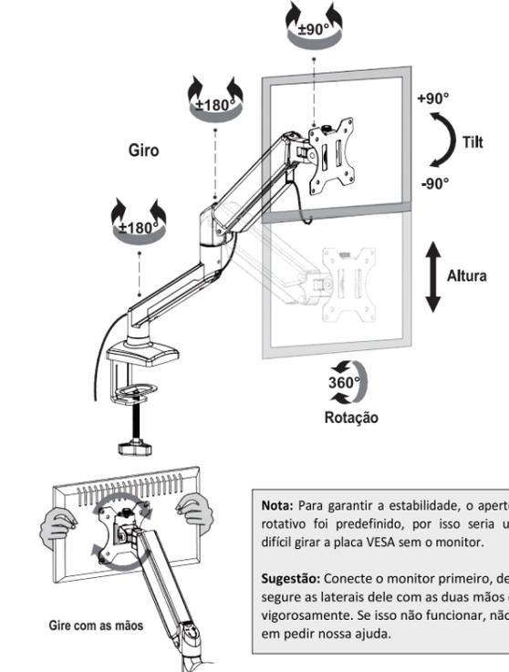
**Nota:** Para garantir a estabilidade, o aperto do eixo rotativo foi predefinido, por isso seria um pouco difícil girar a placa VESA sem o monitor.
