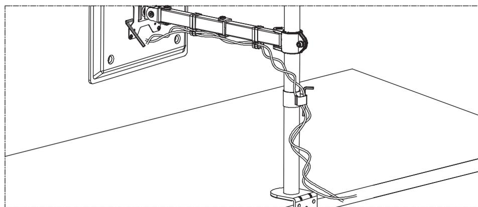
Use a chave Allen fornecida (j) para fazer os ajustes necessários em cada braço. Segure os fios no lugar com um clipe de cabo (Wire Clip -h)
