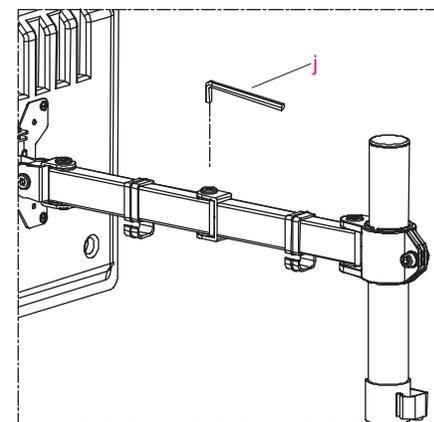
Se um monitor estiver mais baixo, remova a porca e gire o parafuso no sentido anti-horário com a chave Allen fornecida (j) para levantar o monitor. Instale a porca após o ajuste.
