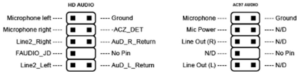
O conector interno F\_AUDIO é compatível com HD\_AUDIO ou AC97, acima é possível identificar a função de cada pino do conector.
