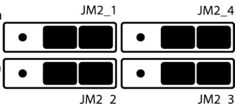
Posicione o jumper de acordo com a ilustração a direita para utilizar SSDs M.2 compatíveis com a chave M (Padrão NVMe).
