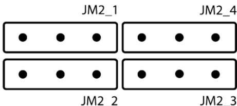
Posicione o jumper de acordo com a ilustração a direita para utilizar SSDs M.2 compatíveis com as chaves B ou B+M (Padrão SATA 3.0 GB/S).
