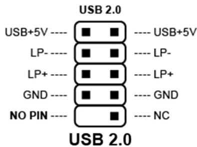
*O conector USB 2.0 interno possui a orientação de pinos de acordo com a figura a esquerda.*
