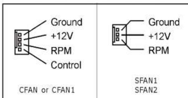
*Os conectores listados na imagem à esquerda fornecem energia e controlam o cooler do processador.*
