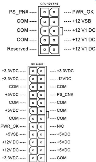
O conector CPU 12V 4+4P é o responsável pela alimentação de energia do processador, o design do conector é de apenas uma orientação de instalação. Tenha certeza de que os conectores estão instalados corretamente.
