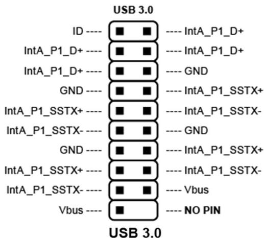
*O conector USB 3.0 interno possui a orientação de pinos de acordo com a figura a esquerda.*
