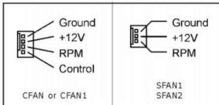
*O conector listado na imagem à esquerda fornece energia e controla o cooler do processador.*
