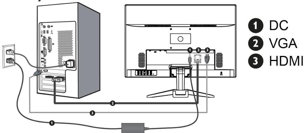
1. Conecte a fonte externa ao conector DC (Item 1), esta deverá ser conectada a uma tomada AC que poderá ser 110 V ou 220 V.
