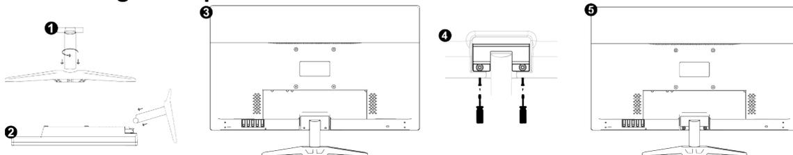
1. Encaixe a coluna do pedestal na base, seguindo o desenho da figura 1. Ao inserir a coluna do pedestal completamente, você ouvirá um som de 'clique', indicando que a coluna está firme e segura.
