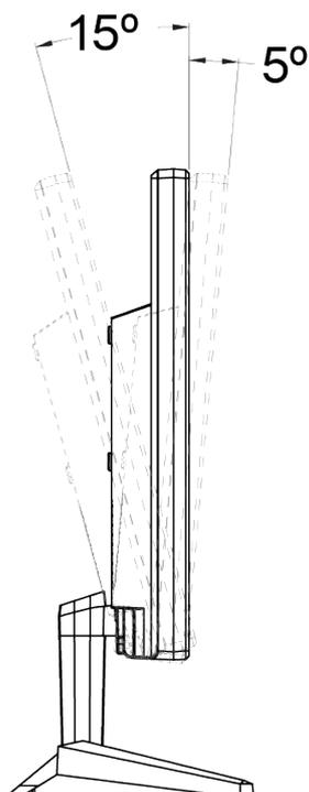
É possível ajustar o monitor BM24K2HVW ou BM24K2HVWW para uma leve inclinação para trás de até 15° ou para uma leve inclinação para frente de até 5°.
