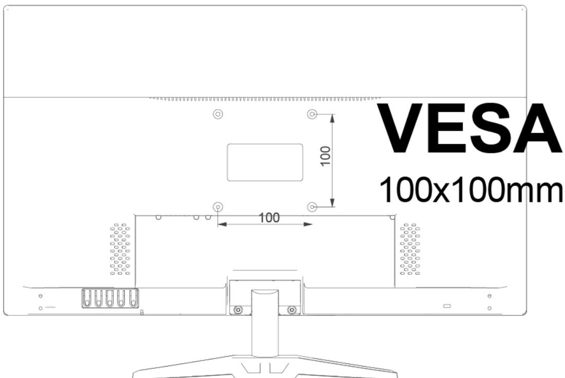
Para realizar a montagem VESA será necessário utilizar 04 parafusos M4x20mm, cada um deverá ser instalado de acordo com o desenho da figura acima.
