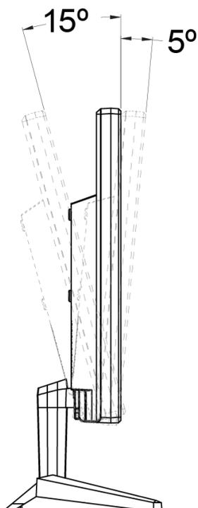
É possível ajustar o monitor BM22X3HVW/ BM22X3HVWW para uma leve inclinação para trás de até 15° ou para uma leve inclinação para frente de até 5°.
