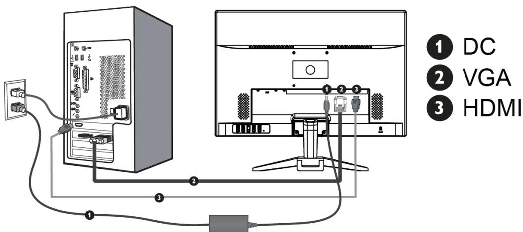
1. Conecte a fonte externa ao conector DC (Item 1), esta deverá ser conectada a uma tomada AC que poderá ser 100V ou 240V;
