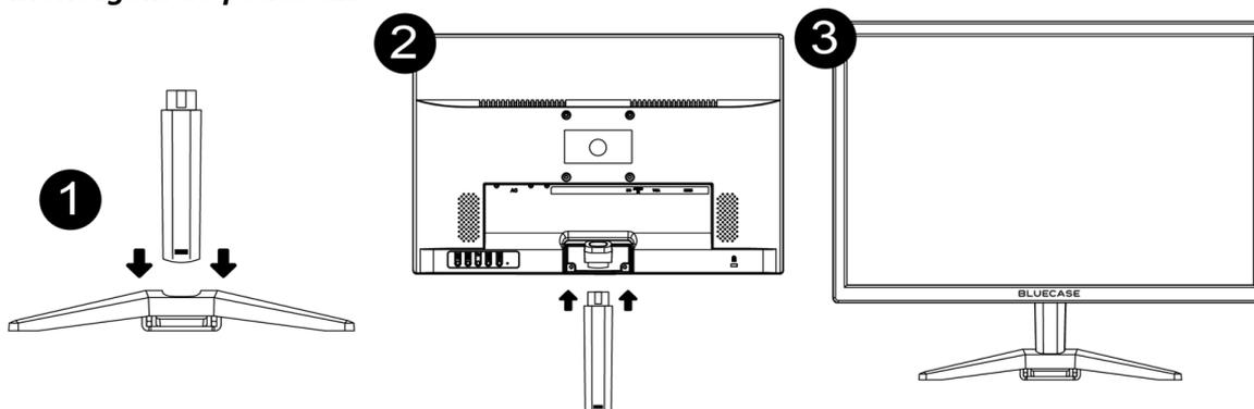
**A montagem do pedestal não requer ferramentas adicionais. Siga os passos abaixo para a montagem:**
