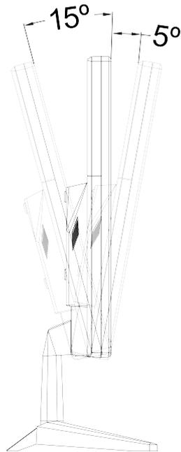
É possível ajustar o monitor BM22D4HVW para uma leve inclinação para trás de até 15° ou para uma leve inclinação para frente de até 5°.
