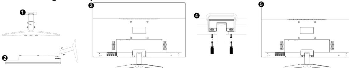
1. Encaixe a coluna do pedestal na base, seguindo o desenho da figura 1. Ao inserir a coluna do pedestal completamente, você ouvirá um som de 'clique', indicando que a coluna está firme e segura.
