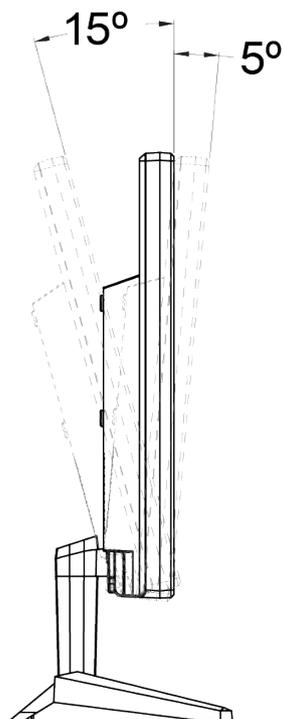
É possível ajustar o monitor BM20K4HVW ou BM20K4HVWW para uma leve inclinação para trás de até 15° ou para uma leve inclinação para frente de até 5°.
