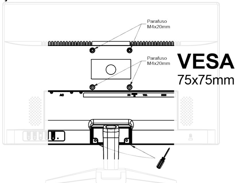
Para realizar a montagem VESA será necessário utilizar 04 parafusos M4x20mm, cada um deverá ser instalado de acordo com o desenho da figura acima.
