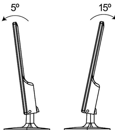
É possível ajustar o monitor BM154K2HVW para uma leve inclinação para trás de até 15° ou para uma leve inclinação para frente de até 5°.
