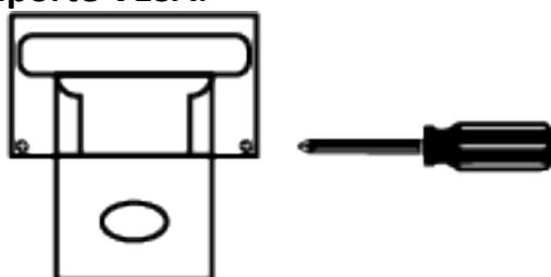
Para realizar a montagem do produto em um suporte VESA, é necessário utilizar uma chave philips para remover os dois parafusos localizados na área de montagem da coluna do pedestal, após a remoção será possível liberar instalar o monitor em um suporte VESA.
