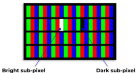
**Bright pixel:** Quando todos os três sub-pixels se tornam permanentemente ligados, gerando um pixel totalmente branco;
