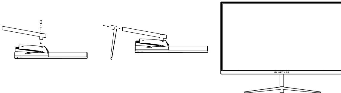
**1. Posicione a tela em uma superfície não abrasiva e firme com cautela para não danificar a mesma. Retire a base e a coluna do pedestal da embalagem, monte a coluna do pedestal utilizando um parafuso do kit de parafusos conforme indicado na figura a esquerda. Ao finalizar tampe com o acabamento.**
