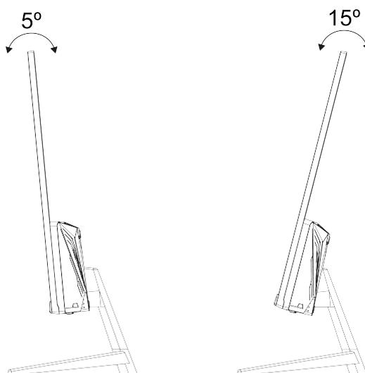
É possível ajustar o monitor, para uma leve inclinação para trás de até 15° ou para uma leve inclinação para frente de até 5°.
