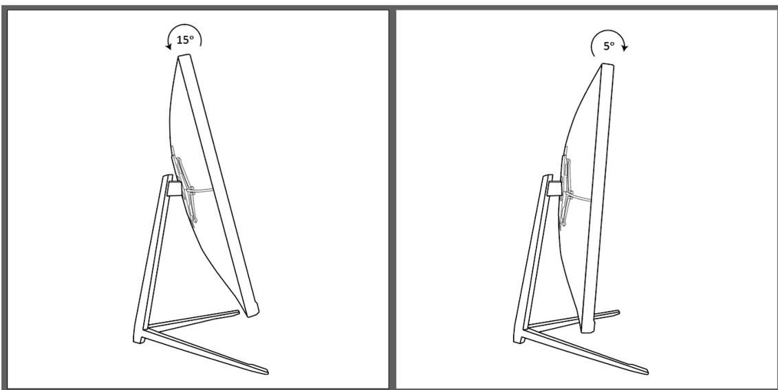
É possível ajustar o monitor BM2716GW para uma leve inclinação para trás de até 15°.
