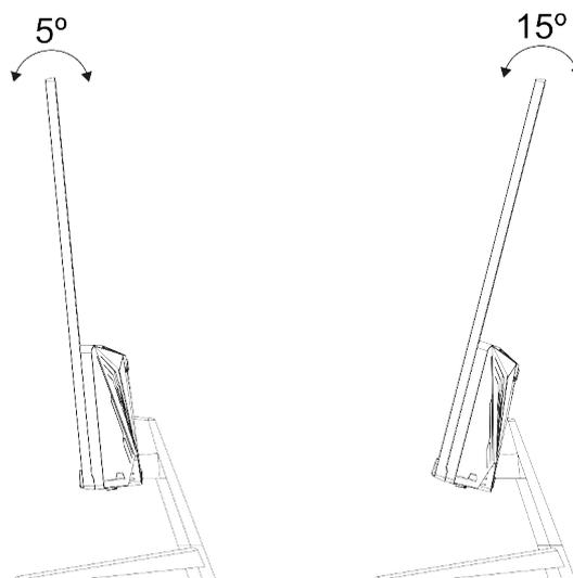
É possível ajustar o monitor BM24FFH1GC ou BM24FFH1GCW para uma leve inclinação para trás de até 15° ou para uma leve inclinação para frente de até 5°.
