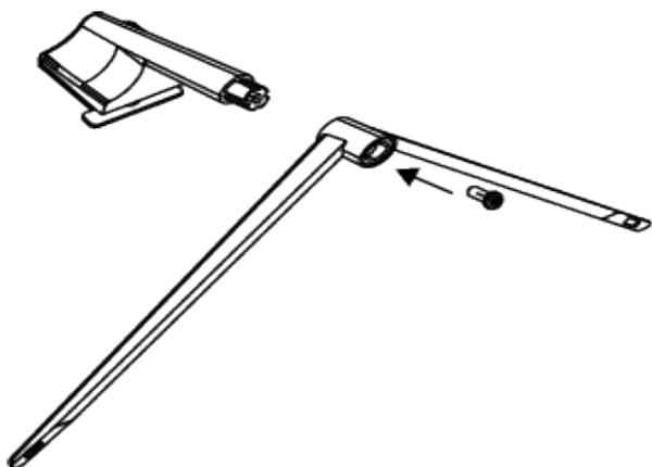
**1. Retire a base e a coluna do pedestal da embalagem, monte a base utilizando um parafuso do kit de parafusos conforme indicado na figura a esquerda.**
