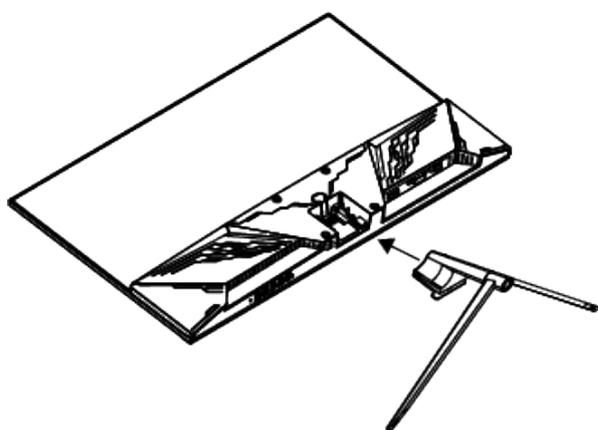
**2. Posicione a tela em uma superfície não abrasiva e firme com cautela para não danificar a mesma. Insira a coluna do pedestal no local indicado na figura a esquerda.**
