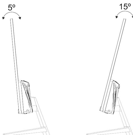
É possível ajustar o monitor BM24FFD2GCW, para uma leve inclinação para trás de até 15° ou para uma leve inclinação para frente de até 5°.
