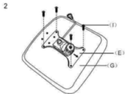
Alinhe o mecanismo da cadeira no fundo da base do assento e parafuse o mecanismo à base.
